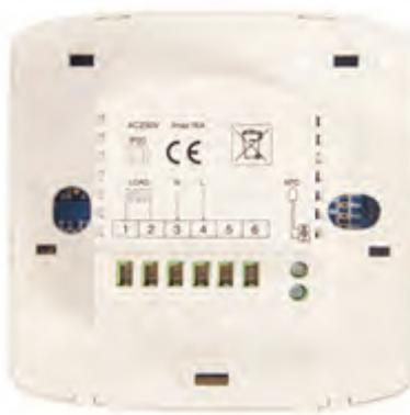
Для терморегуляторов «REXANT®» датчик температуры (NTC) подключается к клеммам 7 и 8. Переменное напряжение питания (220 В) подается на клеммы 3 и 4. Клеммы 1 и 2 предназначены для подключения выводов нагревательного мата к терморегулятору.
