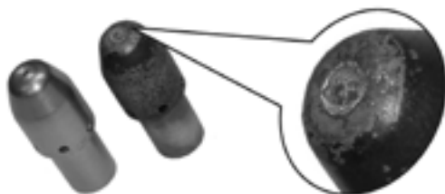
Рис. 7.2. Пример износа катода.
