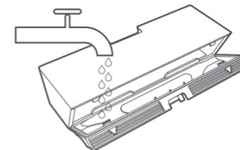
3. Снимите фильтр, как показано на схеме, а затем потрясите его, чтобы удалить лишнюю воду. Перед тем как установить фильтр на место, дайте ему высохнуть.
