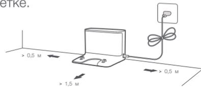
Примечание: обеспечьте не менее 0,5 м свободного пространства с боковых сторон и 1,5 м с лицевой стороны док-станции. Подключите шнур электропитания к док-станции и убедитесь, что на полу отсутствуют провода и предметы (в том числе шнур питания от зарядной станции), чтобы устройство не загудало в них и не повредило предметы.
