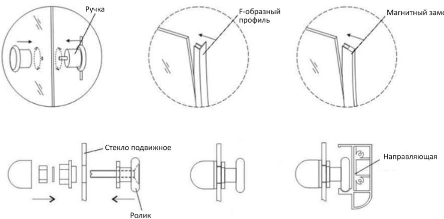
Отрегулируйте вертикальное положение дверей при помощи регулировочных винтов на верхних роликах.
