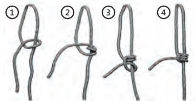
рис. 2 Схема завязывания узла на перемычке санок.
