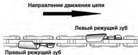
Рис. 12 Определение типа режущего зуба
