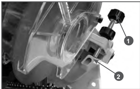
Рис. 17 Винт регулировки глубины заточки
