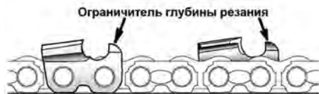
Рис. 13 Расположение пильной цепи на направляющей шине станка
