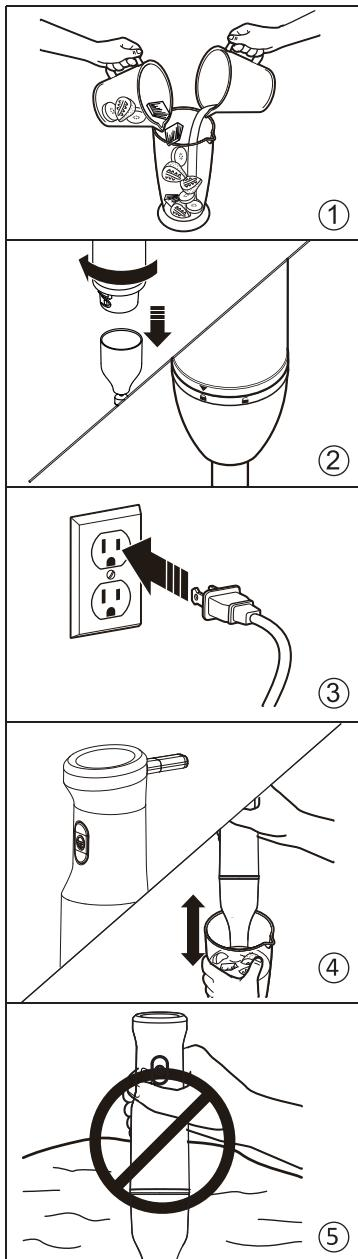
Соберите прибор, установите требуемую насадку и проверьте надежность всех креплений. Прибор в собранном виде показан на рисунке.
