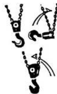
Рис. 6 Неправильное положение крюка.
