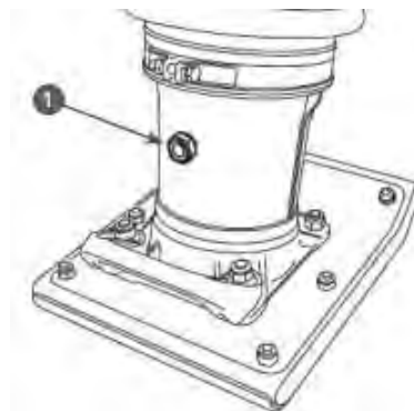
Рис.7 - Проверка уровня масла в рабочем цилиндре 1. Пробка со смотровым отверстием для контроля уровня масла
