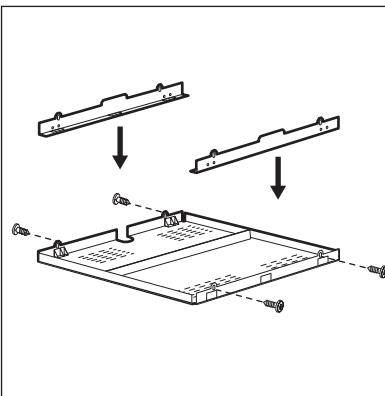
В случае использования защитного экрана (приобретается отдельно) фронтальный 2-мм вентиляционный зазор и защита пола под варочной панелью не являются обязательными. В ряде стран защитный экран может отсутствовать в списке доступных дополнительных принадлежностей. Обратитесь к своему поставщику.
