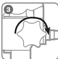
**Поверните винт сброса давления в положение «Закрыть»**
