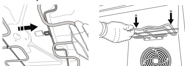
**2.** Чтобы вернуть нагревательный элемент в рабочее положение, поднимите и немного вытяните его на себя, а затем вставьте планку крепления в соответствующее гнездо.
