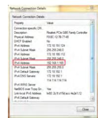
② Установите IP-адрес компьютера (например, 192.168.1.165)
