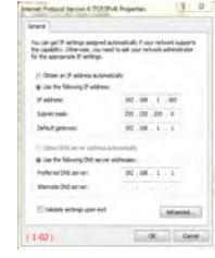
③ Или добавьте компьютер и сетевые камеры в один сегмент сети (например, 192.168.1.165)
