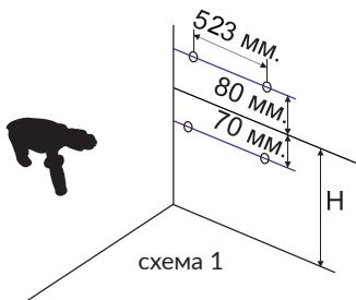
Просверлить отверстия и установить дюбеля (поз.6).
