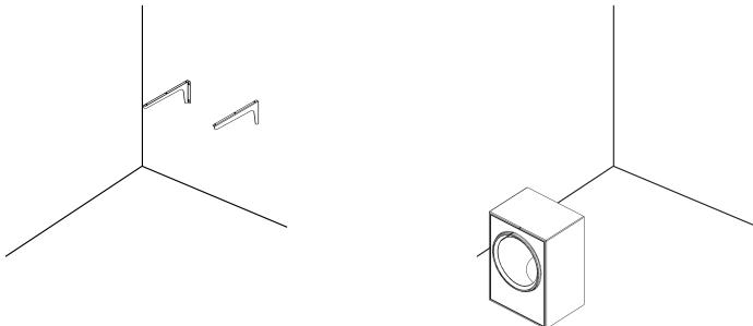
Разметить место для установки кронштейнов (схема 1) так, чтобы в результате, раковина и стиральная машина расположились согласно схемы 2.
