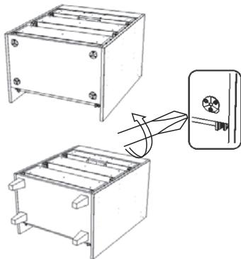
Установить крепежные пластины опор, крепеж саморез 4x16, предварительно сняв заглушки в местах крепления (вариант с декоративными опорами)
