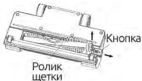
2. В случае намотки волос на ролик пневматической щетки\*, снимите щетку, нажмите на специальную кнопку и извлеките ролик для очистки.
