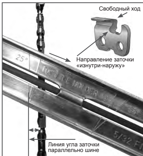
Рис.18 Определение угла заточки
