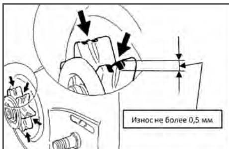
Рис.16 Проверка износа звездочки
