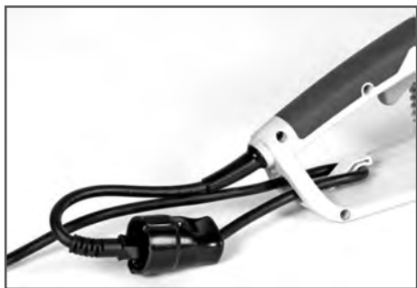
Рис. 9 Крепление удлинительного кабеля
