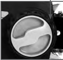
Рис. 7 Регулировка натяжения цепи
