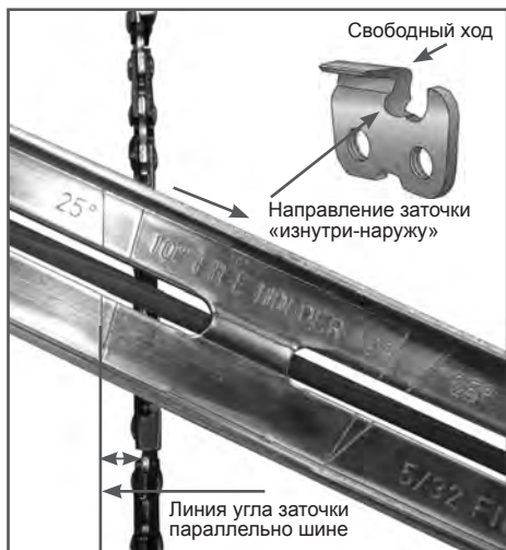
Рис. 16 Определение угла заточки
