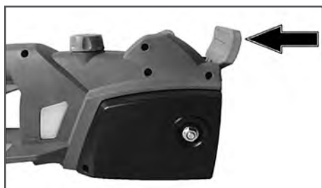
Рис. 2 Отключение тормоза цепи
