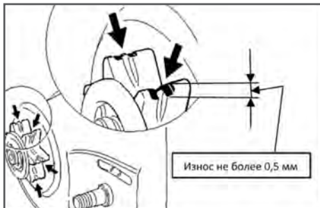
Рис. 14 Проверка износа звездочки
