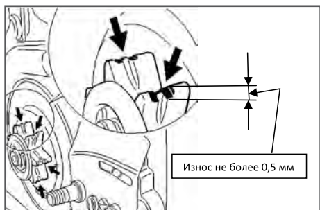
Рис.10 Проверка износа звездочки
