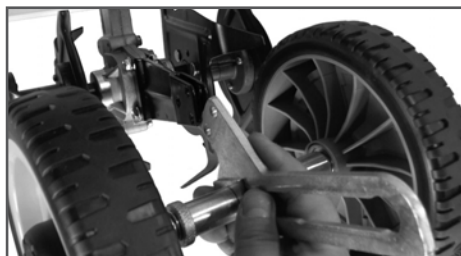
Рис. 6 Установка кронштейна колес
