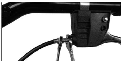
Рис. 10 Фиксация троса газа
