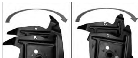
Рис. 3 Маркировка и направление вращения фрез
