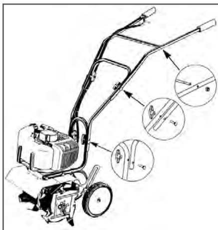
Рис. 8 Установка ручек управления
