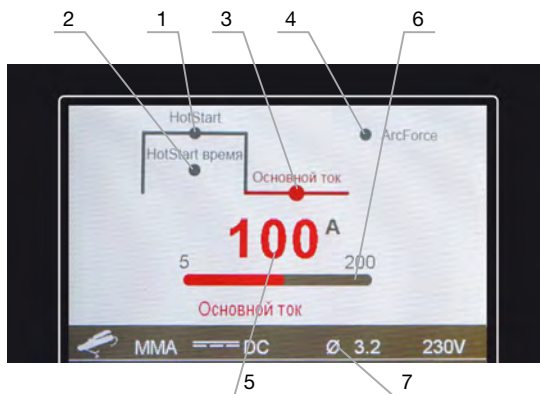
Рис. 6.3 Циклограмма процесса MMA
