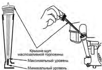
Рис. 7 Проверка уровня масла в картере
