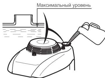
Рис. 5 Максимальный уровень топлива
