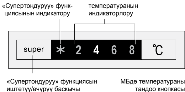
3-сүрөт – Башкаруу панели
