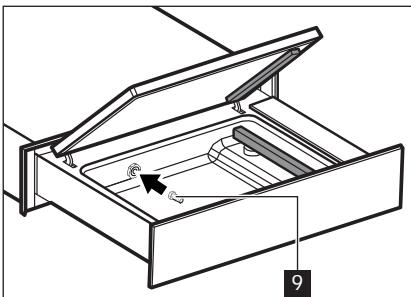
لإجراء التفريغ الخارجي قم بتثبيت الوصلة 9 المرفقة مع الجهاز داخل الحوض.
