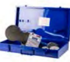
CM-02 EASY | 700              | 16-50             | Сварочный аппарат; облегченная подставка; сменные нагреватели 20, 25, 32, 40 мм; ножницы для резки труб диаметром 16-42 мм; ключи для крепления сварочных насадок; металлический бокс                                                                                                          |
