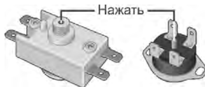
Рисунок 3. Схема расположения кнопки термовыключателя
