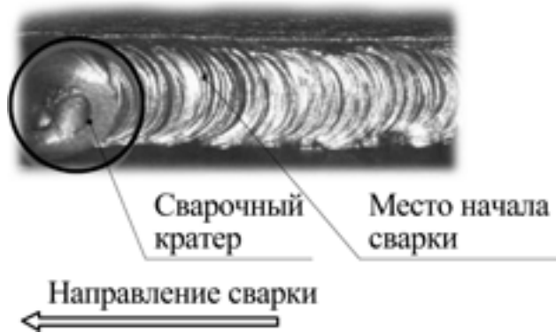
Рис. 9.4. Начало сварки при смене электрода.
