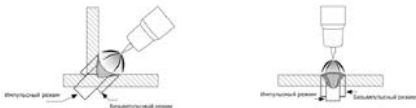
Рис. 8.7. Выделяемое тепло в импульсном и безимпульсном режимах.
