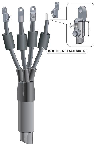
**6.1** Снять с концов каждой жилы изоляцию на длине, равной глубине хвостовика наконечника, и очистить растворителем поверхности оголенных участков жил;
