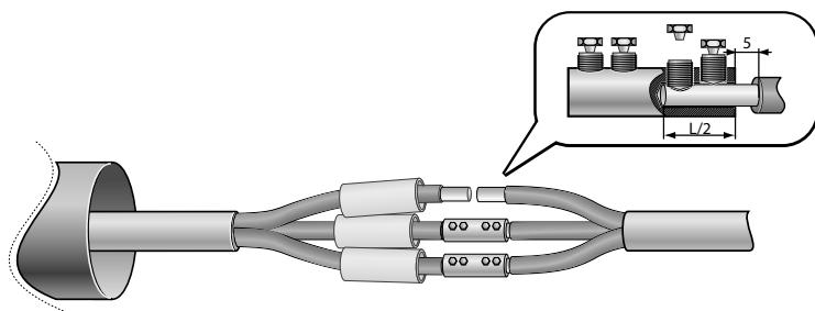
**3.1** Произвести изгиб жил таким образом, чтобы соответствующие жилы обоих концов кабеля расположились на одной горизонтали друг с другом (стык в стык);
