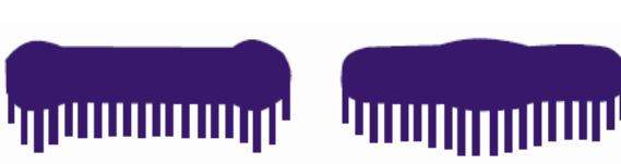
Образцы с неправильным распределением материала в факеле
