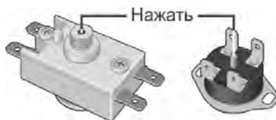
Рисунок 2. Возможные схемы расположения кнопки термовыключателя
