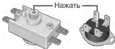
Рисунок 3. Возможные схемы расположения кнопки термовыключателя
