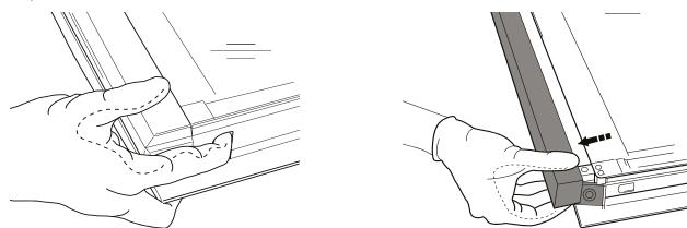
**3.** Внутреннее стекло установлено правильно, если в левом углу видна буква "R", а прозрачная поверхность (без принта) смотрит вверх. Сначала вставьте в пазы длинную сторону стекла с буквой "R", затем опустите его в предусмотренное положение.
