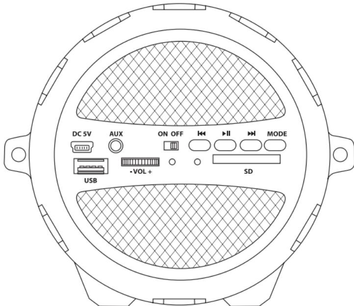
**DC 5V** - Разъем для подключения провода питания.
