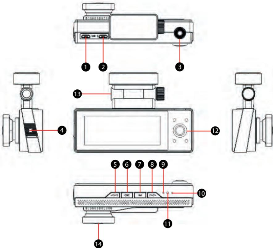
1. Разъем подключения задней камеры (Type-C)
