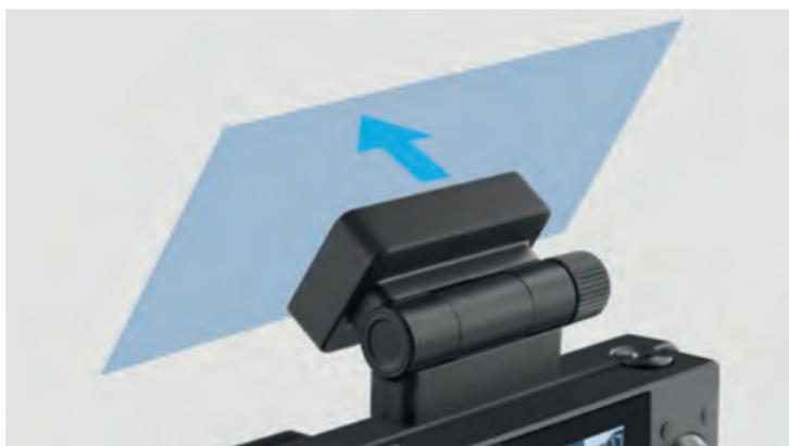
**ВНИМАНИЕ!** Установка крепления на лобовое стекло должна производиться строго в горизонтальном положении как можно ближе к центральной вертикали ветрового стекла.
