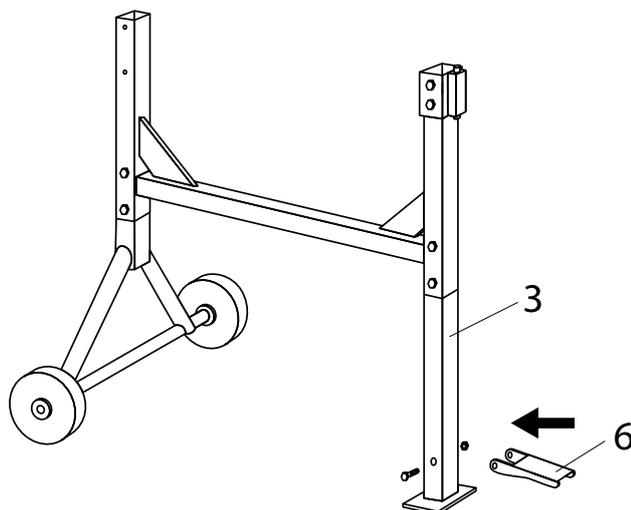
Установить на опору поз. 3 педаль поз. 6, закрепить болтом М8 х 70 и гайкой М8 со стопорным кольцом.
