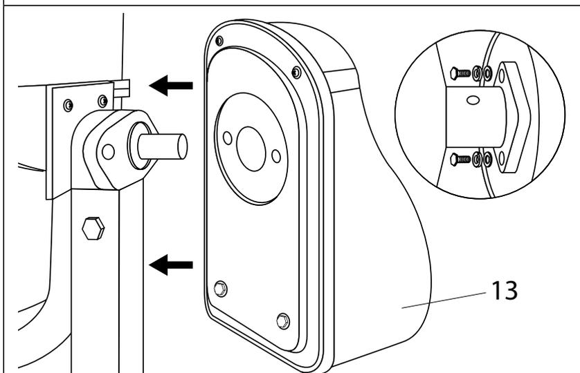
Uniti cablul poz.13 si fixati cu bolturi M8x25, saiba Grower 8 si saiba 8.
