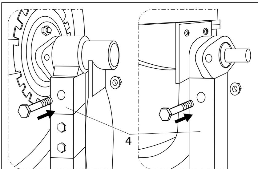
Монтирайте болтовете M8x65 и закрепете опората на траверсата върху рамката поз. 4 с гайки M8, както е показано на рисунката.
