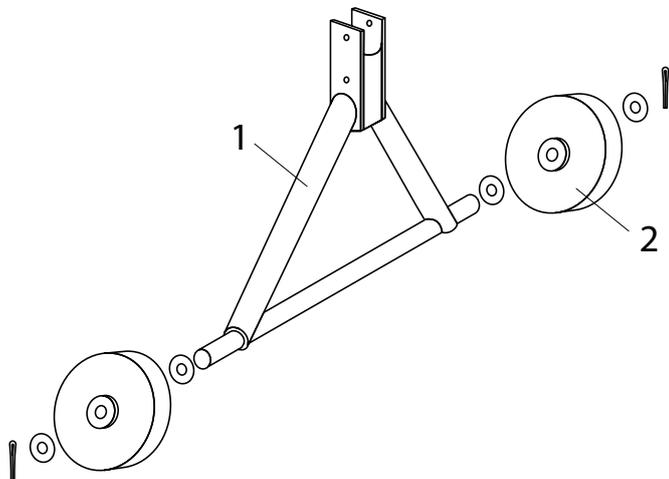
Монтирайте върху оста на колесната опора поз. 1 шайбата 27, след това колелото поз. 2 и още една шайба 27. Монтирайте на в отверстието на оста шпелнта по такъв начин, че те да се намират от външната страна на шайбата. За изваждане на шпелнтовете използвайте плоски клещи.
