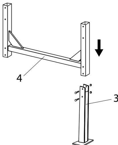
Cuplati cuportul poz. 3 cu rama poz. 4 cu ajutorul bolturilor M8x65 si intariti cu piulitele M8. Cuportul trebuie sa fie instalat din partea ramei cu 3 orificii (pentru modelul Cm120 – din parte arcului).
