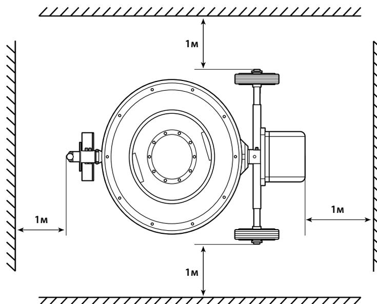
Funcționarea betonierii este de natură ciclică cu următoarea secvență: încărcare, amestecare, descărcare. Betoniera trebuie instalată pe o suprafață plată și orizontală. Se recomandă ca betoniera să fie pornită în poziția verticală a tamburului.
