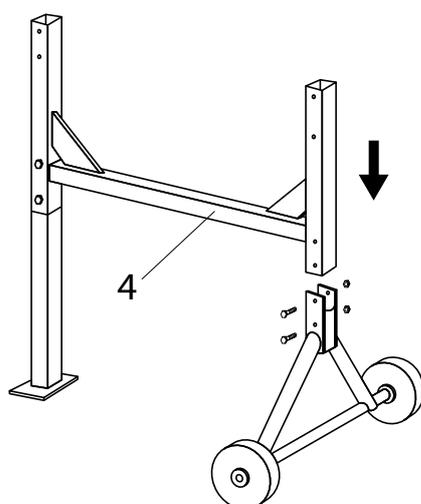
Cuplati suportul cu roti in asamblare cu rama poz. 4 cu ajutorul bolturilor M8x65 si fixati cu piulitele M8.
