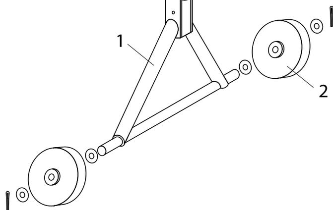
Instalati pe axa suportului de roti poz.1 saiba 27, apoi roata poz. 2 si inca o saiba 27. Introduceri in orificiile axului pene in asa fel incat, ele sa se afle din partea exterioara a saibei. Scoateti penele, folosind clesti.
