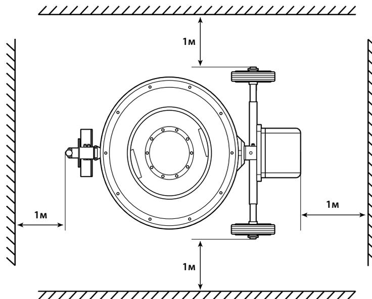
Работата на смесителя е с цикличен характер с такава последователност: натоварване, смесване, разтоварване. Смесителят следва да се монтира върху равна и твърда хоризонтална повърхност. Препоръчва се включването на смесителя във вертикално положение на барабана.
