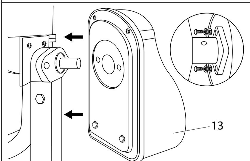
Присъединете задвижващия блок поз. 13 и го закрепете с болтове M8x25, със застопоряваща шайба 8 и шайба 8.
