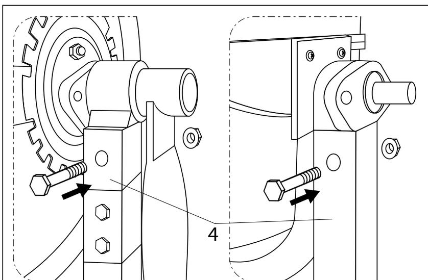
Instalati bolturi M8x65 si fixati suporturile traversei pe rama poz.4 cu piulitele M8, asa cum este aratat in imagine.
