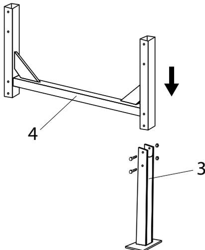
Съединете опората поз. 3 с рамката поз. 4 с помощта на болтовете М8х65 и я закрепете с гайки М8. Опората следва да бъде поставена от страната на рамката с 3 отверстия (за моделите СМ120 – от страна на пружината)..
