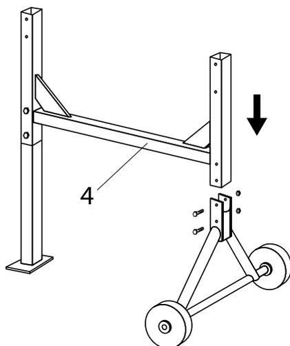
Съединете колесната опора с рамката поз. 4 с помощта на болтове М8х65 и я закрепете с гайки М8.
