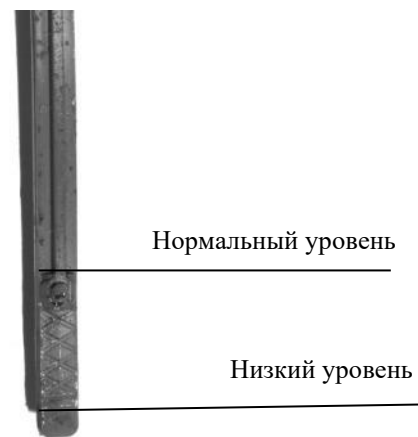
Рисунок 6 – Проверка уровня масла в корпусе редуктора
