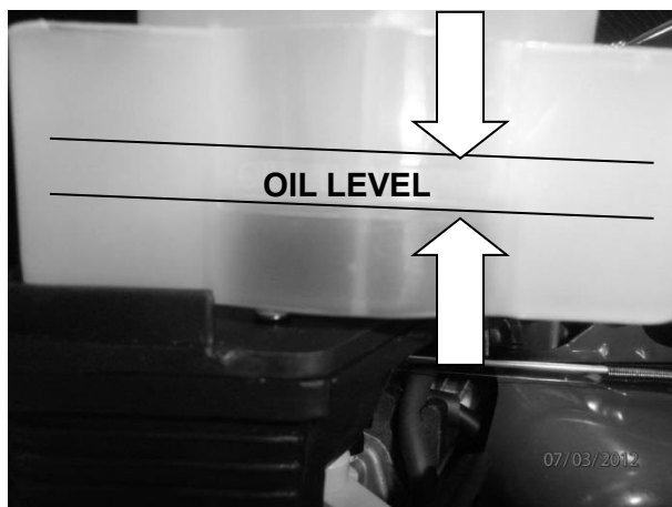
Рисунок 8 – Уровень масла в корпусе воздушного фильтра
