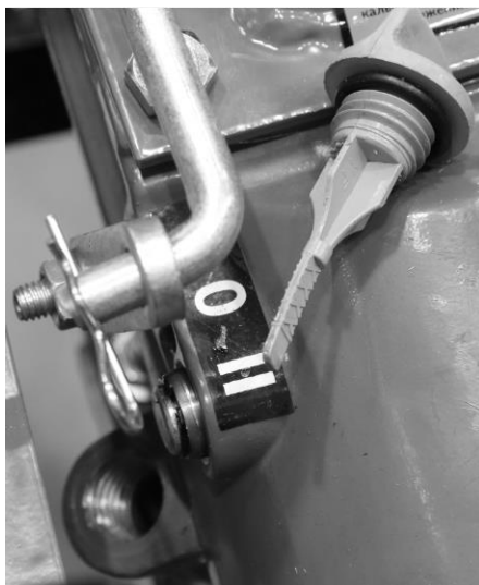
Рисунок 6 – Проверка уровня масла в корпусе редуктора
