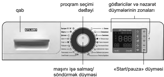
Şəkil 1 – İdarəetmə paneli
