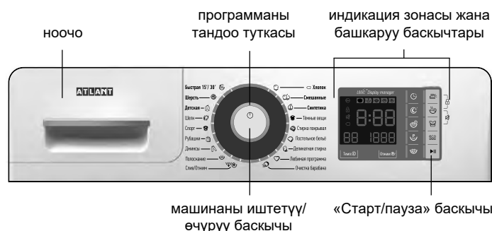
1-сүрөт – Башкаруу панели
