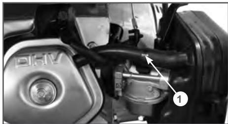
Рис. 15 Трубка системы вентиляции картера
