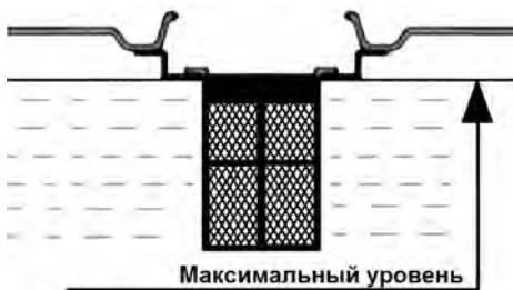
Рис. 10 Максимальный уровень топлива в топливном баке
