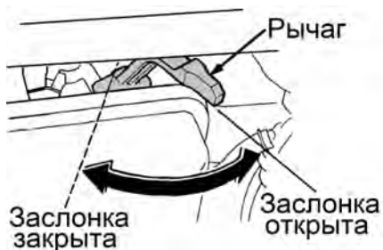
Рис. 11 Рычаг управления воздушной заслонкой
