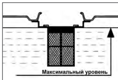
Рис. 7 Максимальный уровень топлива в топливном баке
