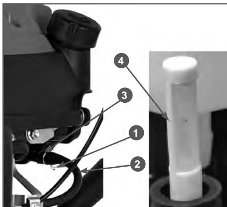
Рис.20 Чистка фильтра топливного бака
