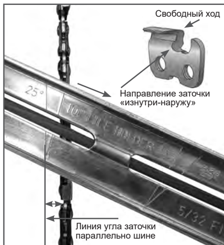
Рис. 16 Определение угла заточки
