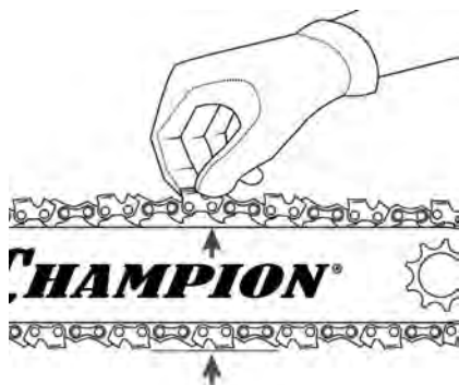
Рис. 4 Проверка натяжения цепи
