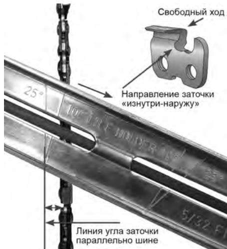
Рис. 15 Определение угла заточки
