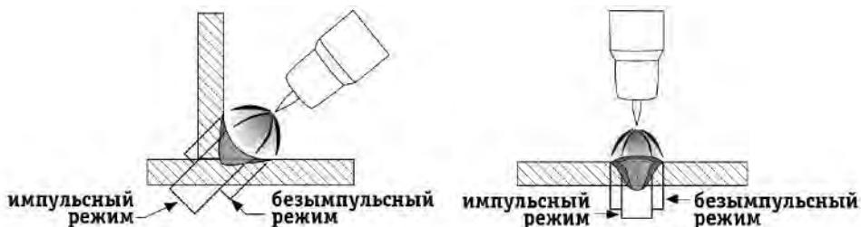
Рис. 9.11.1. Выделяемое тепло в импульсном и безимпульсном режимах.
