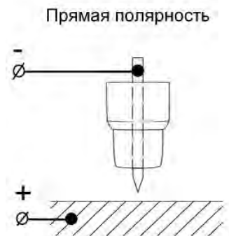
Рис. 9.2.1. Полярность при TIG сварке.
