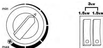
Рис.3 Панель управления на модель BRICK 3: Ручка регулировки термостата (справа). Переключатели режимов (слева)
