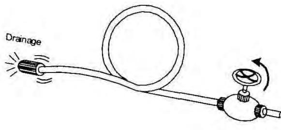
Прочистите шланг струей сжатого воздуха перед соединением шланга с пневмо инструментом. Это предотвратит попадание в инструмент влаги и пыли, находящейся внутри шланга, что в свою очередь предотвратит образование ржавчины или поломок. Чтобы компенсировать падение давления у шлангов более 7,6 м, необходимо увеличить давление или пневмо линию, подводить как можно ближе к рабочему месту.
