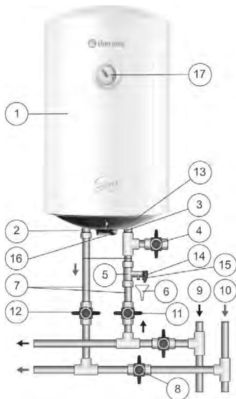
Рисунок 1. Схема подключения ЭВН к водопроводу
