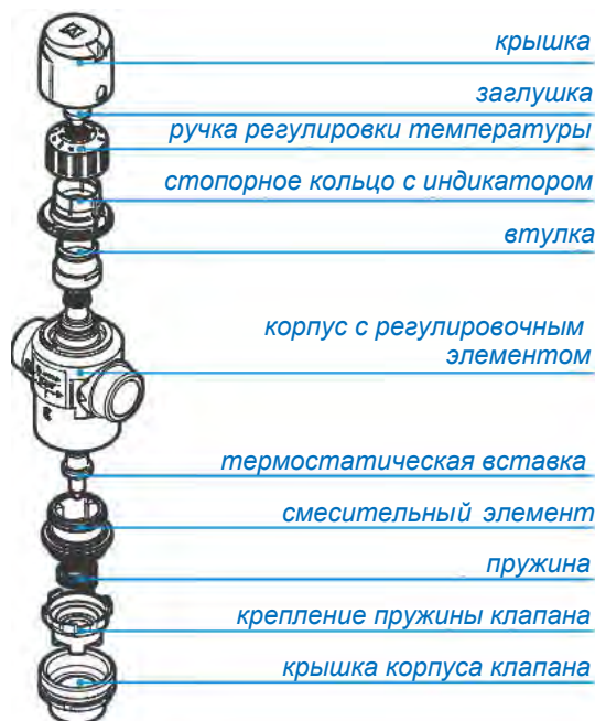
Рис. 2: Конструкция клапана ATM Kvs = 3,2 м³/ч и 4,2 м³/ч
