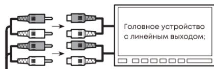
Соедините межблочным кабелем (приобретается отдельно) линейный выход головного устройства с линейным входом на усилителе;
